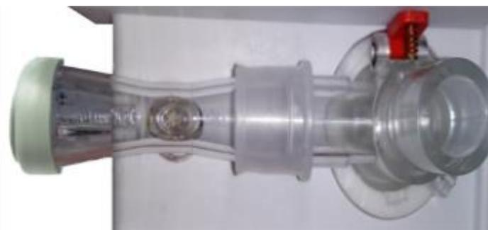
**Рисунок 5-21 - Расположение потокового сенсора на аппарате**
