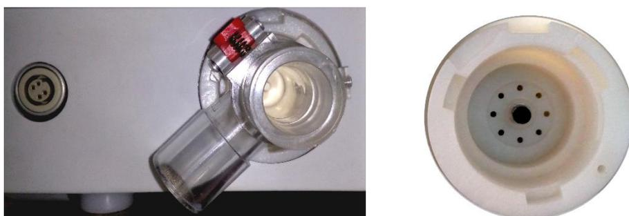
**Рисунок 5-7 – Снятие коннектора клапана выдоха**
