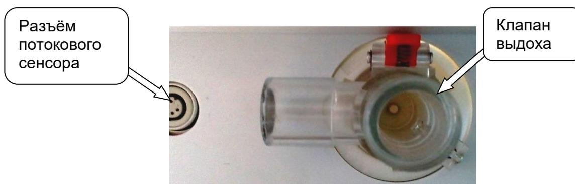
**Рисунок 5-17 - Расположение клапана выдоха и разъёма потокового сенсора**
