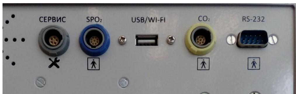
**Рисунок 5-24 - Разъёмы для подключения дополнительного оборудования.**
