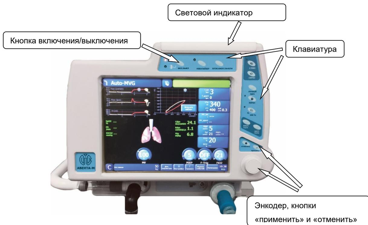
Рисунок 3-3 - Общий вид дисплея и органов управления.
