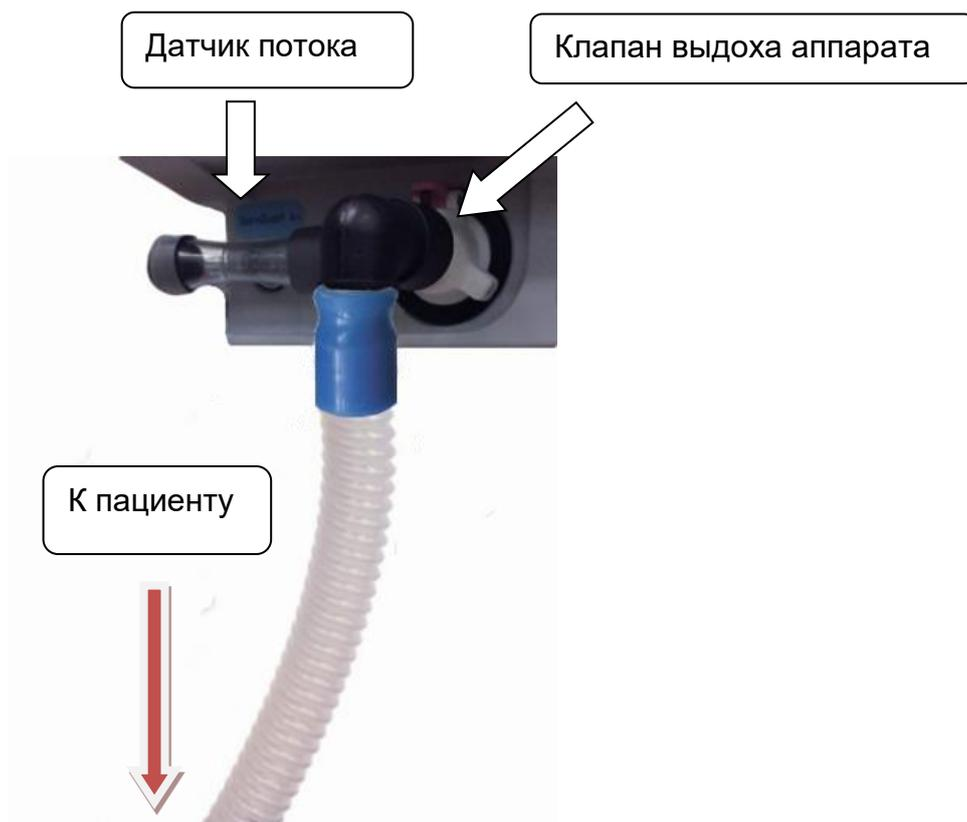
**Рисунок 5-14 – Расположение датчика потока**
