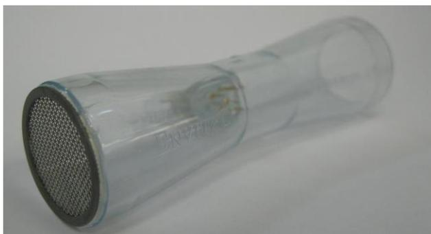
**Рисунок 5-18 - Расположение сетки на потоковом сенсоре.**
