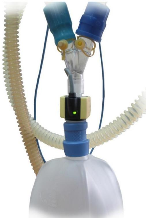
**Рисунок 18-16 - Расположение датчика на аппарате**
